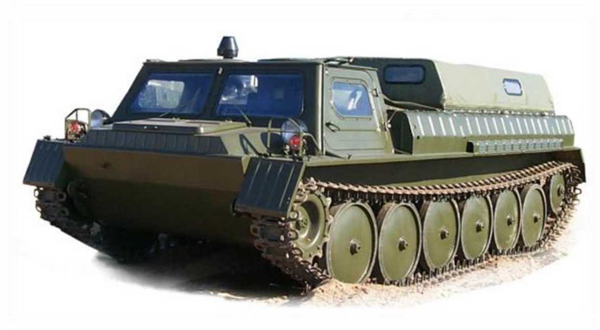
Рис. 2. Гусеничный транспортер средний модернизированный (ГТ-СМ)
